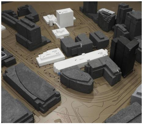
FIGURE 7.3A WIND TUNNEL STUDY MODEL - EXISTING CONFIGURATION
